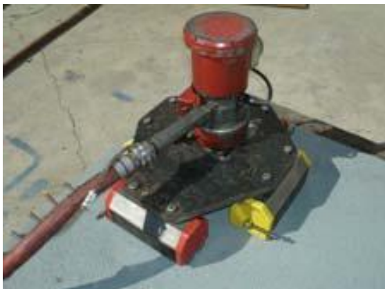
Figur 36 - R1004 FS verktøy låst til struktur vha magnetiske klemmer (7)
