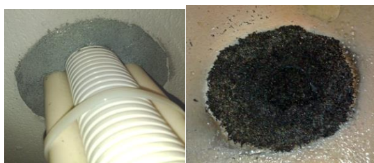
FIGUR 21: EKSEMPEL FRA TEST AV BRANNHEMMEDE, VARMEEKSPANDERENDE GRAFITTFUGEMASSE
