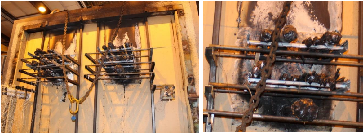
FIGUR 9: GJENOMFØRINGSTESTING VED SINTEF NBL, EKSPONERT SIDE PÅ VERTIKAL SKILLEKONSTRUKSJON
