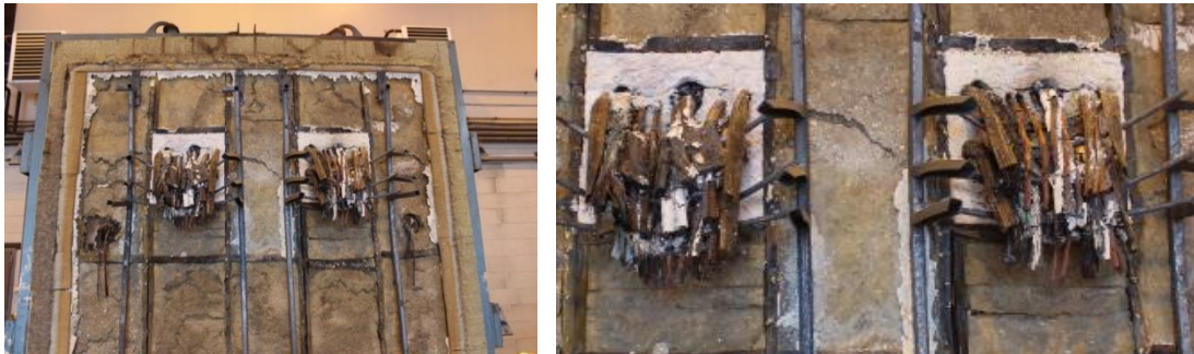
FIGUR 10: GJENOMFØRINGSTESTING VED SINTEF NBL, UEKSPONERT SIDE PÅ VERTIKAL SKILLEKONSTRUKSJON
