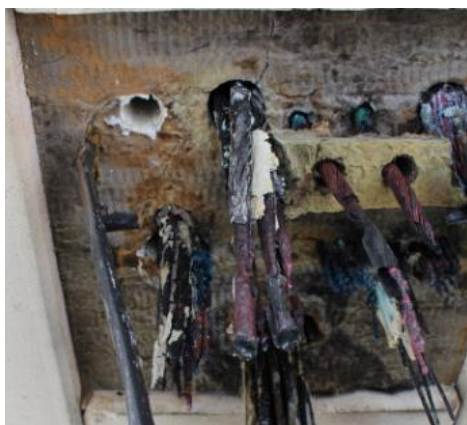
FIGUR 11: GJENNOMFØRINGSTESTING VED SINTEF NBL, EKSPONERT SIDE PÅ HORIZONTAL SKILLEKONSTRUKSJON
