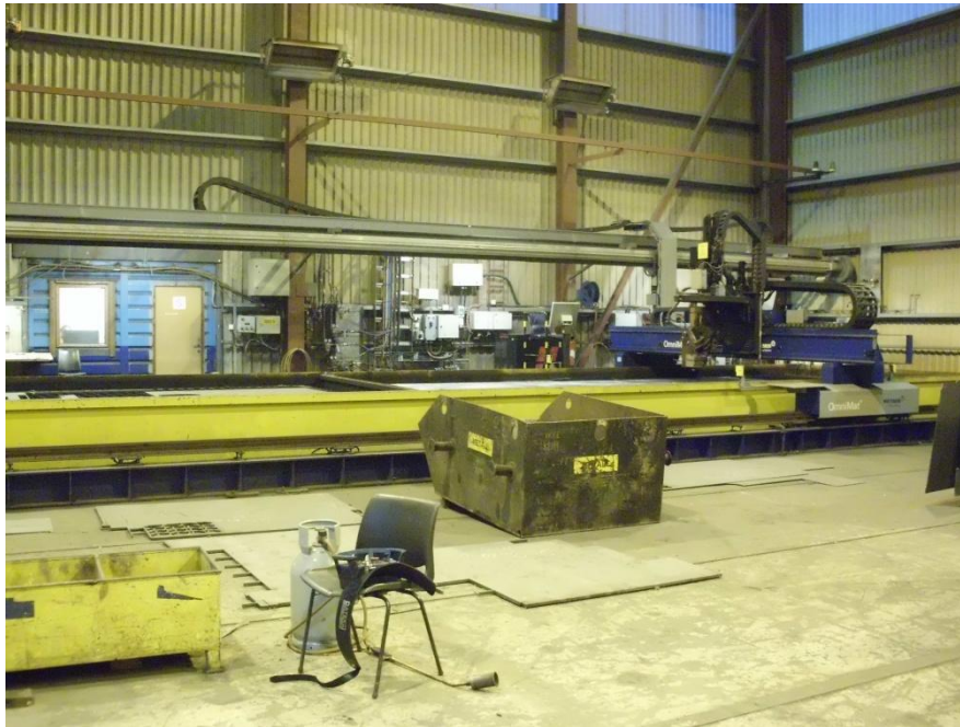
Figur 2 Bilde av brennebordet til Westcon Yard AS, står i platehallen ved Westcon Yard AS i Ølensvåg. Brukt med tillatelse.
