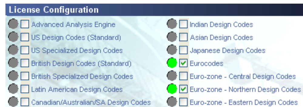
Figur 1-2 STAAD.Pro oppstartsbilde: samsvarende valg av lisenskonfigurasjon, nødvendig for å kunne kjøre kodesjekk med Eurokode 3
