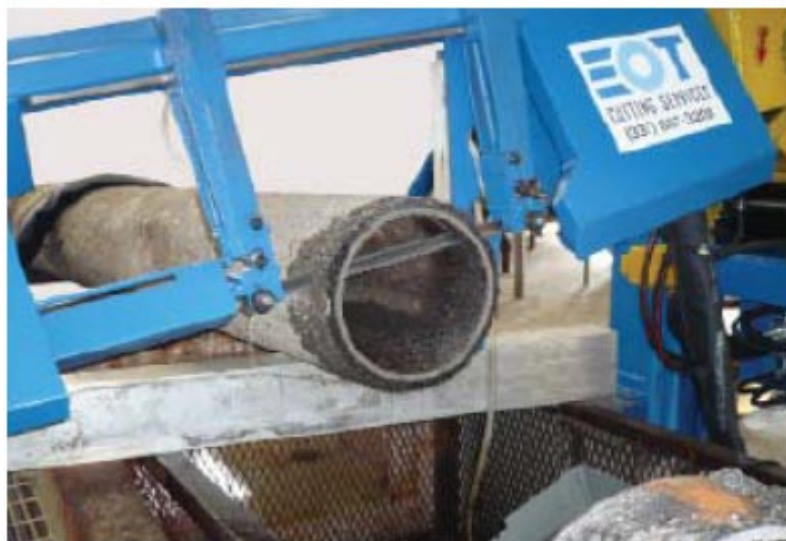
Figur 2.5.1 Kutting av 11 3/4" rør med båndsag [10]
