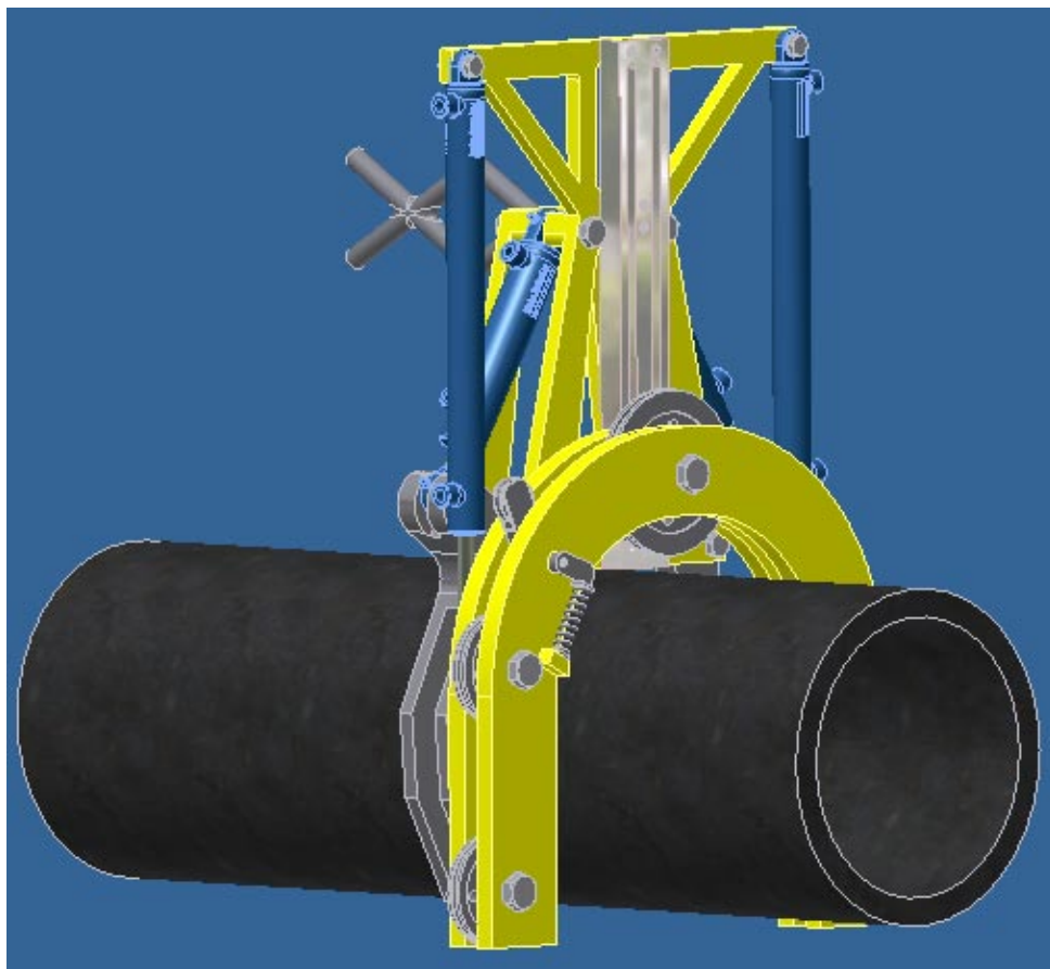
Figur 7.1.4 Kutteverktøy låst på rør i posisjon for utført kutt
