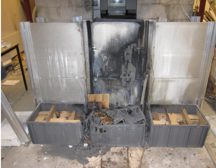
A: Seksjoneringsvegg sett fra varm side
