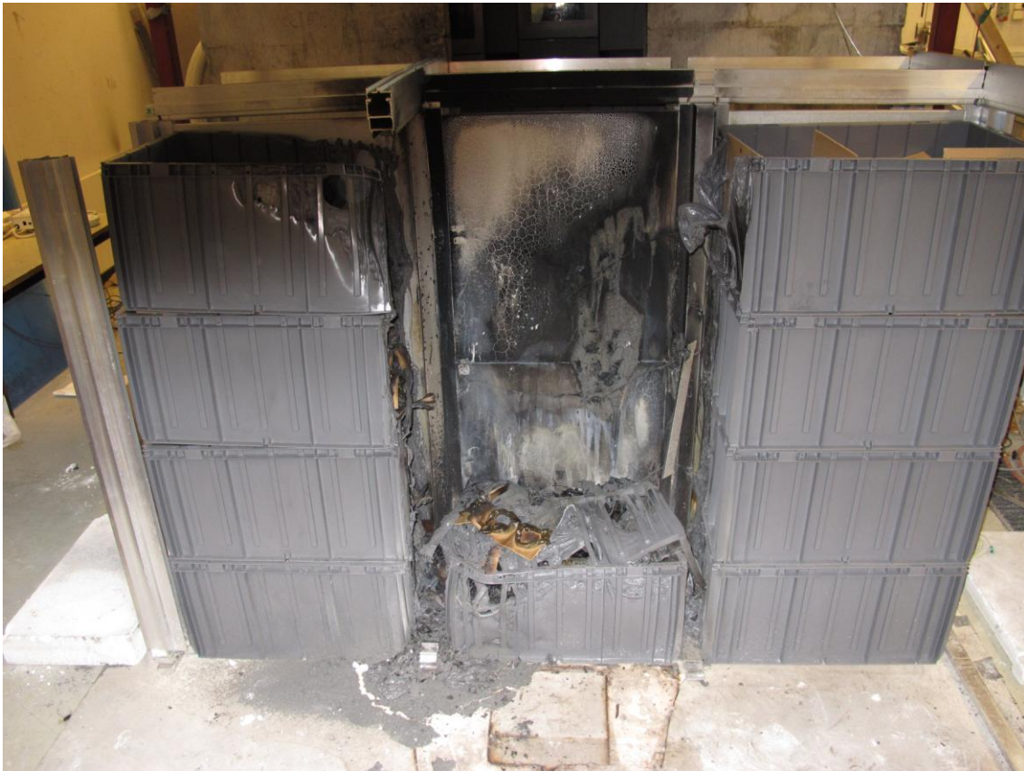
Figur 12-17 Skadeomfang på kasser (varm side)
