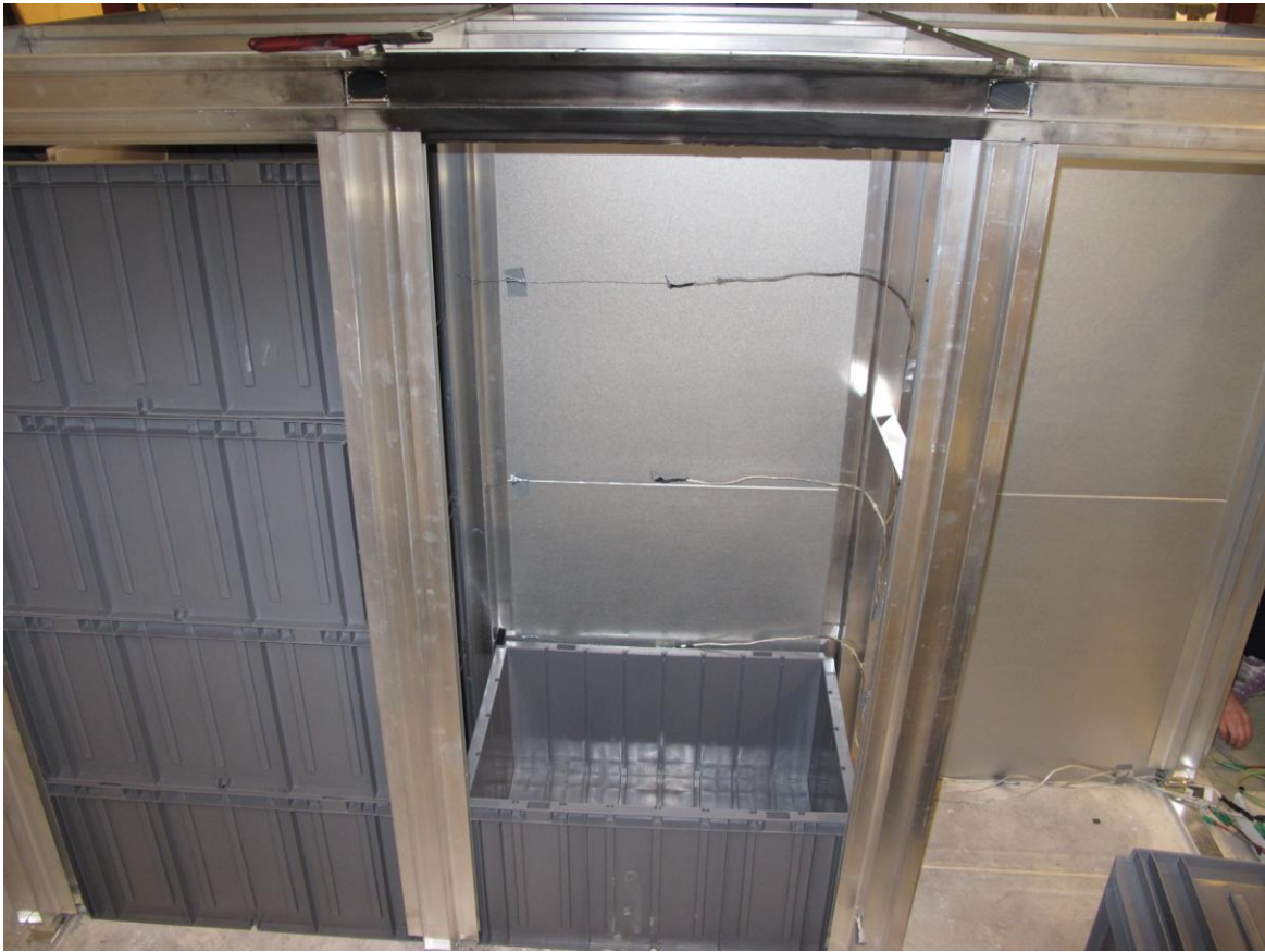
Figur 12-8 Feste av termoelementer på varm side
