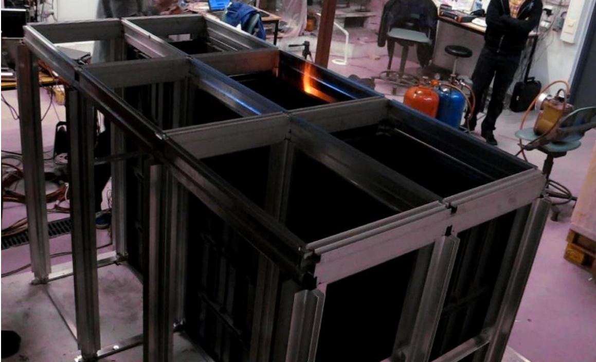
Figur 8-3 Kontinuerlig flamme på kald side etter tilnærmet 10:50 [min:sek]
