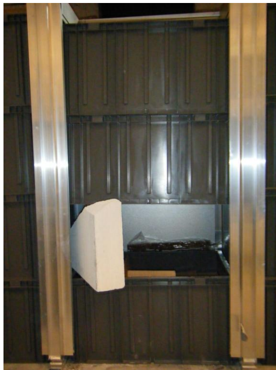
Figur 12-3 Plassering av antenneskilde. Kasser er holdt oppe for antennelse
