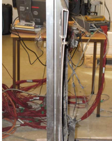
B: Stålplatene har slått inn mot hverandre
