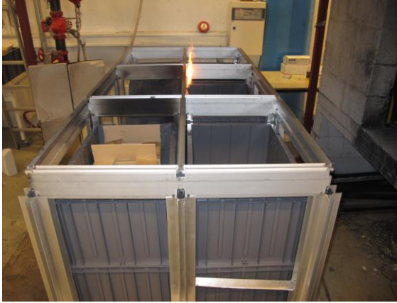
Figur 12-15 Synlig observert brannspredning til kald side etter tilnærmet 17:32 [min:sek]
