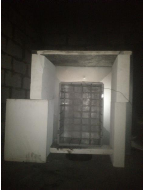
Figur F-1: Oversikt over testoppsett. Gassebrenneren er plassert på baksiden
