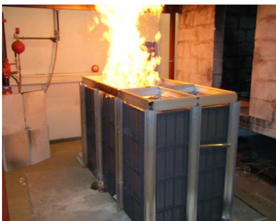
A: Hele midtre celle i brann, og begynnelse av pølbrann på gulvet etter 08:45 [min:sek]
