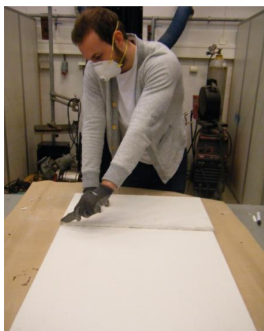
Platene ble kappet med en tapetkniv og skjøtet sammen
