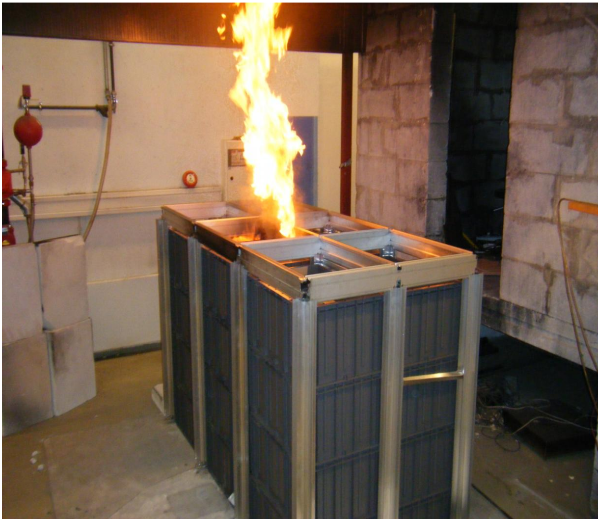
Figur 12-13 Antennelse av røykgasser etter 07:18 [min:sek]
