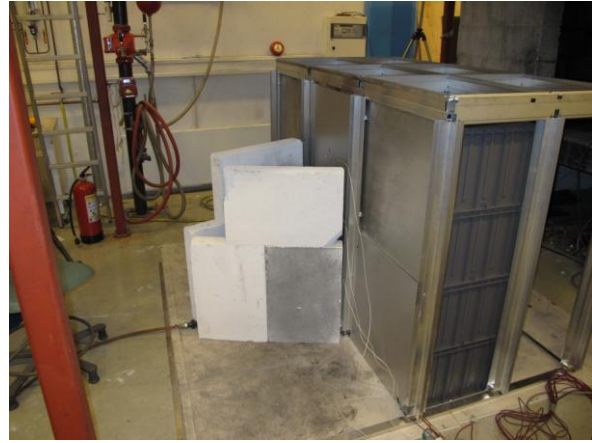
B: Siporex-blokker rundt gassbrenner
