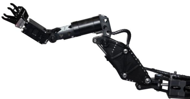
Figur 7.1: Kraftig 7-funksjons manipulator
