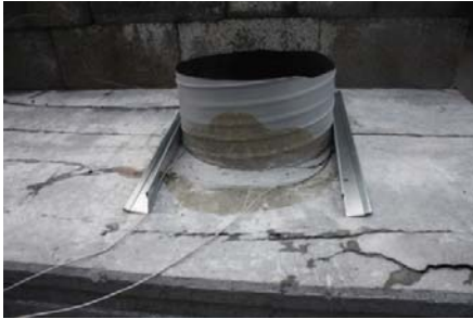
Figur 27, Ventilasjonsrøret og hulldekket etter endt test
