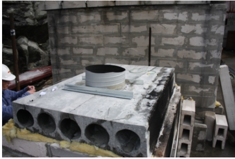
Figur 25, Ventilasjonsrøret og hulldekket etter endt test
