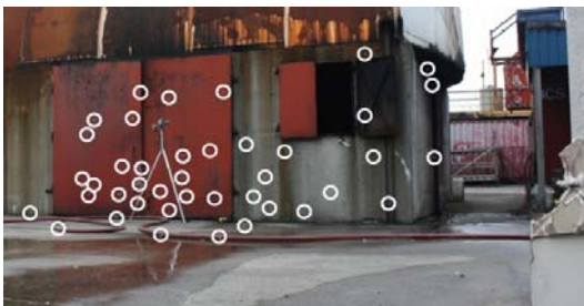
Figur 40, Steinskudd under test, ringet inn i hvitt
