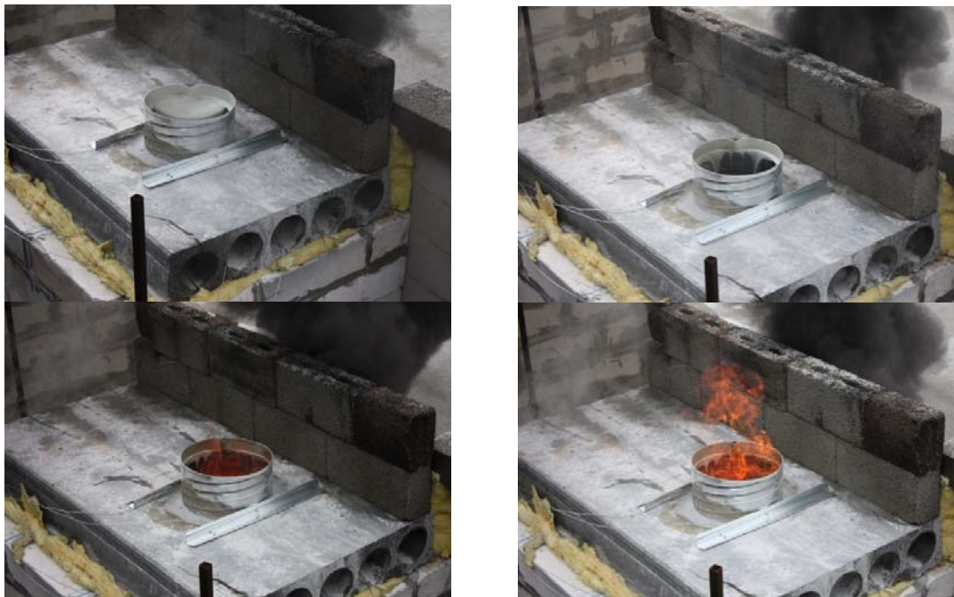
Figur 24, Test 1 da plastlokket over gjennomføringen smeltet og begynte å brenne
