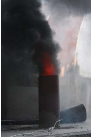
Figur 34, Synlige flammer ut av soilrøret under test 3
