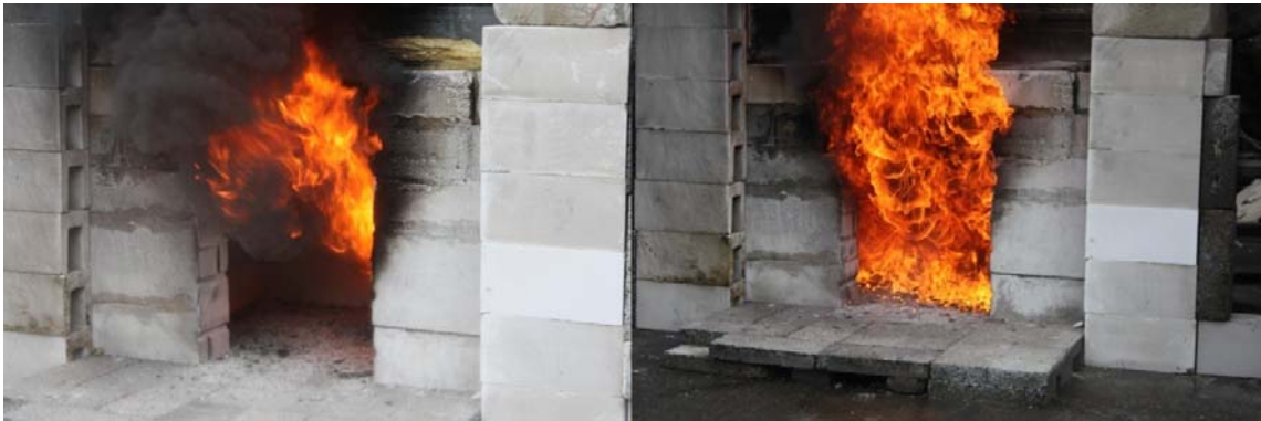
Figur 21, Flammer ut av testrommet, og til høyre vises hvordan brennende diesel rant utover LECA-blokkene
