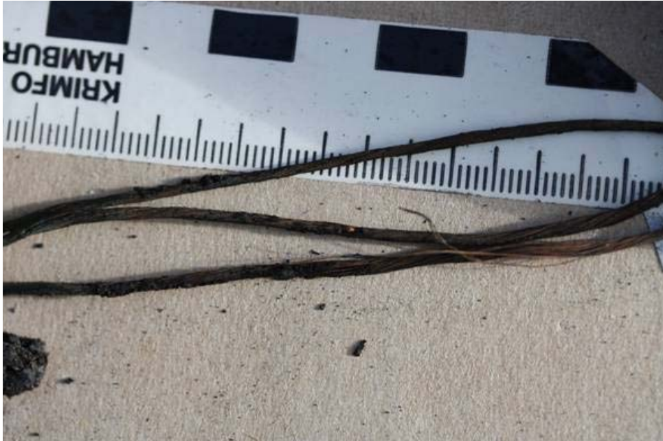
Kortslutningssporene ligger overfor hverandre og bekrefter kortslutning og nærhet til arnested
