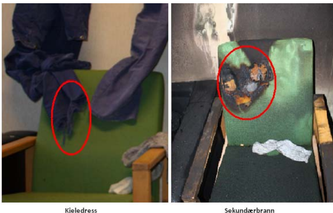
Figur 6:1 Sekundærbrann, trolig forårsaket av kjeledress
