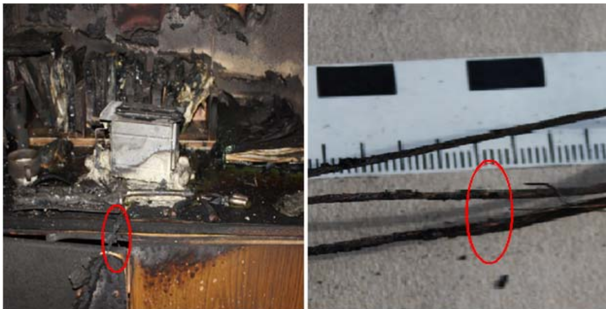
Figur 5:7 Kortslutningsspor på brødrister
