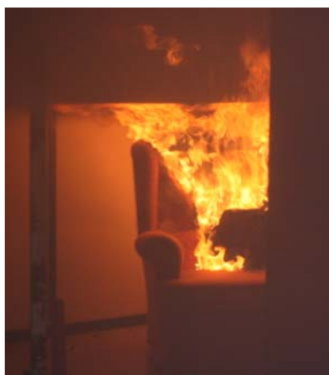
Figur 5:5 Oppsamling av brennbare gasser og flammer under bokhyllen
