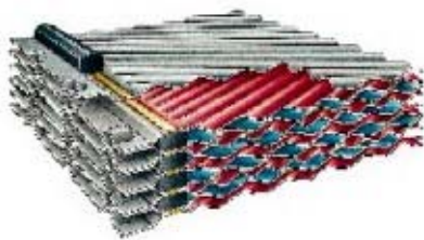
Figur 8: Snitt av en veksler med sveiste plater på ammoniakk siden og pakninger på vann siden.
