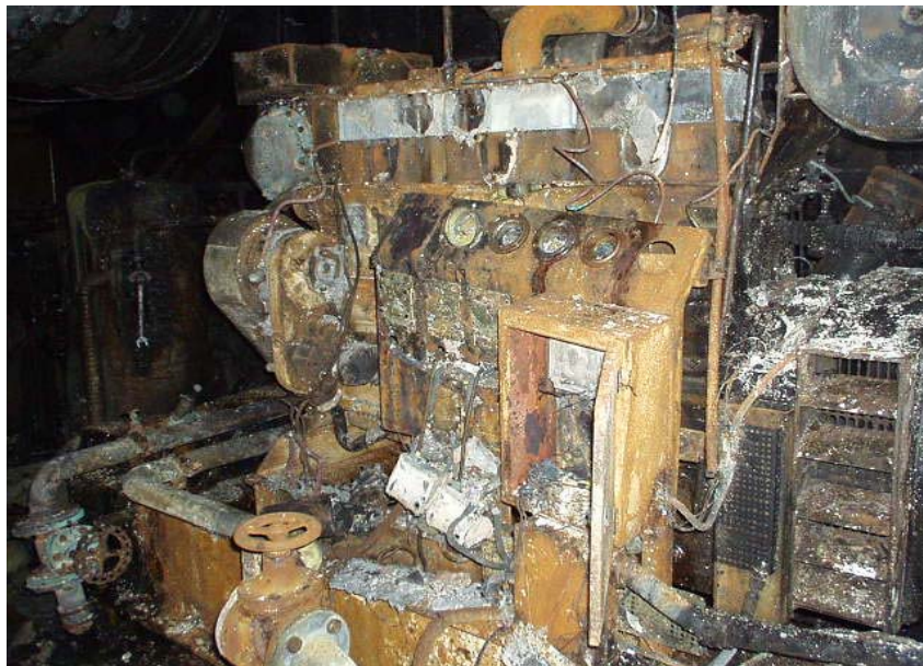
Bilde 2.1 Utbrent hjelpemotor
