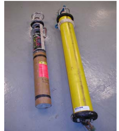
Figur 2: Transponder og transponderbatteri.
