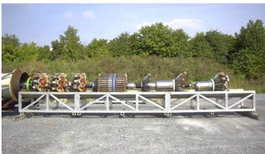
Figur 1: Inspeksjonspigg på vei inn i rørsluse.
