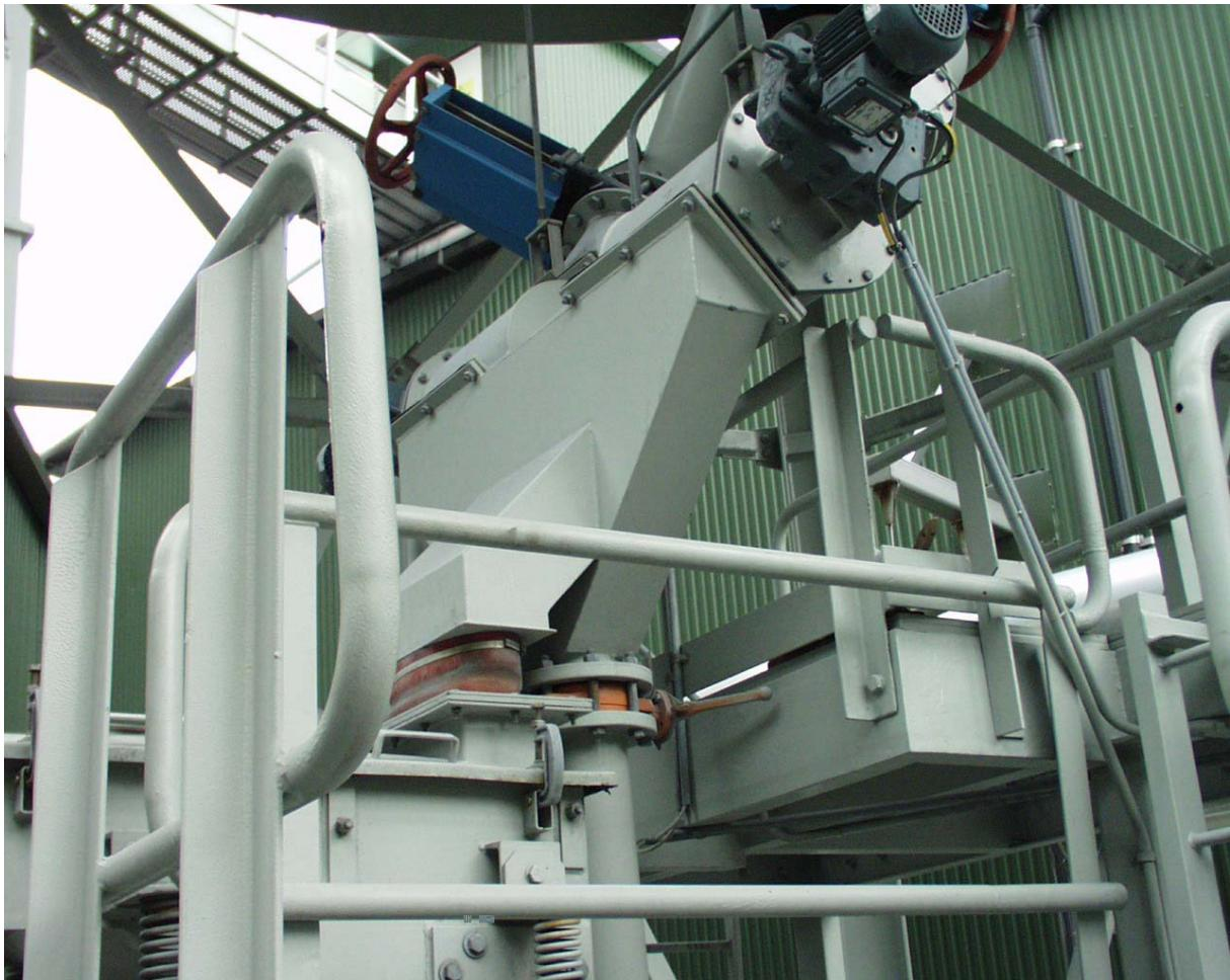
Slusematar: Dette er ei løysing som er levert av Alstom. Det er ein rotor med 12 skålstilteskovler med fast slusevolum( $0,020\text{m}^3$ ). Ein justerer mengda ein vil ha gjennom ein matar med justere turtal på motor som driver rotoren, slik at tartalet på denne aukar. Ein vil då få ei lineær kurve som viser utmatingsvolum (vedlegg 2).
