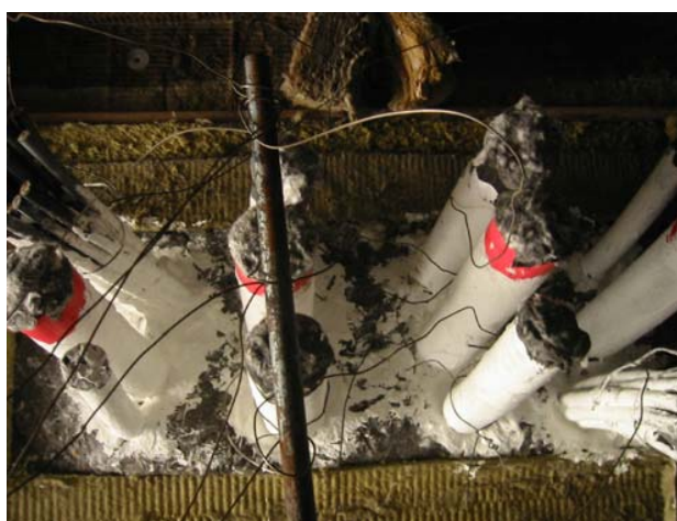
Bilde 4.14 – Termoelementer ueksponert side, test 3
