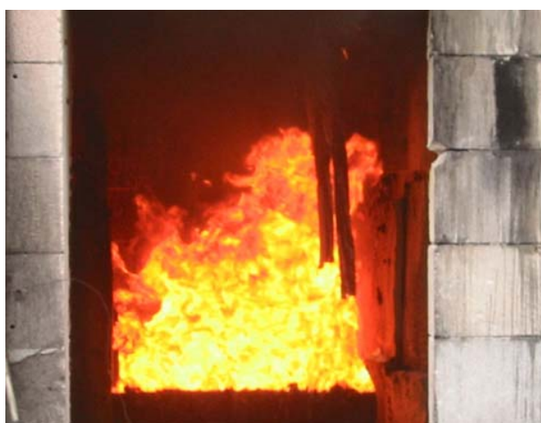
Bilde 4.15 – Kabler som henger rett nedover
