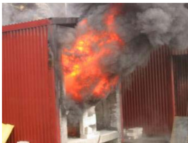
Bilde 4.1 – Brannen i test 1, etter overtenning
