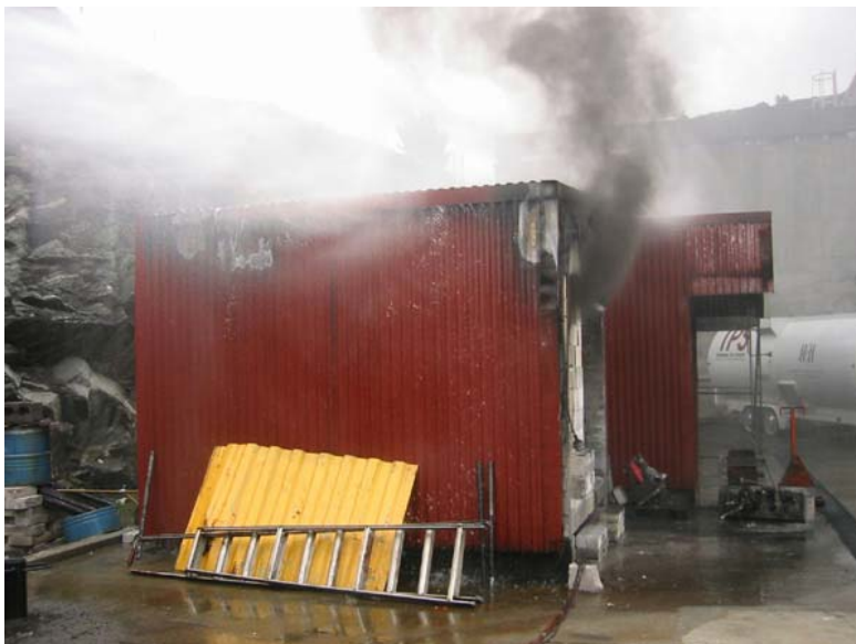
Bilde 4.17 – Kjøling av ISO-rommet etter testens slutt
