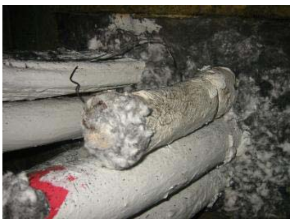
Bilde 4.8 – Ekspandert kabelmaling, ueksponert side
