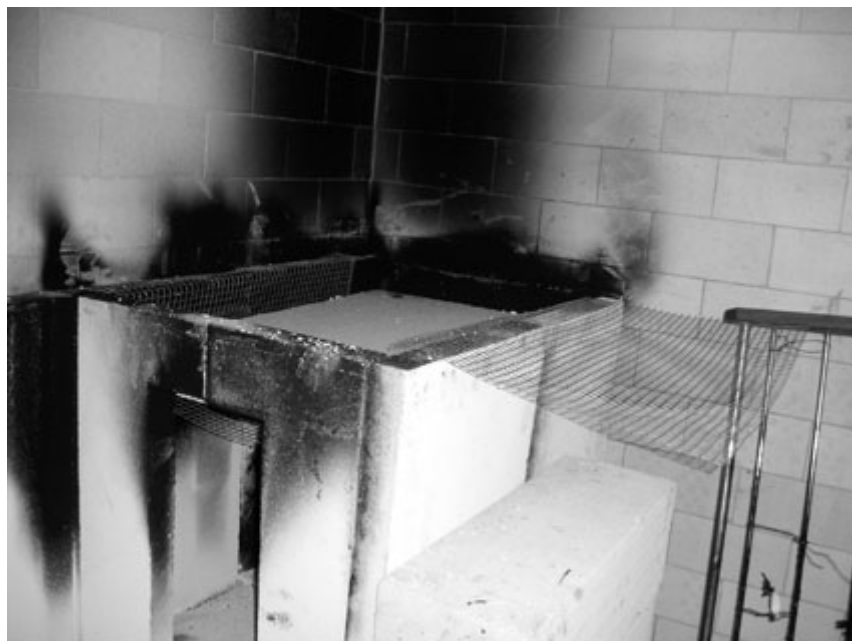
Figur 7-1 Bilde av oppsett for brannforsøk med isopor i tak.
