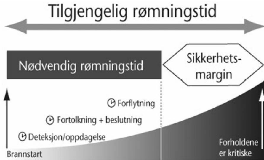
Figur 3: Inndeling av tiden fra brannstart til kritiske forhold.
