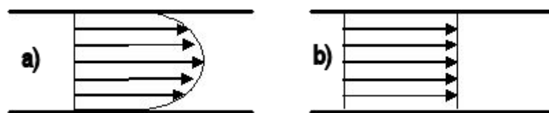
Figur 3-1: Hastighetsprofiler: a) Laminær strømming, b) Turbulent strømming
