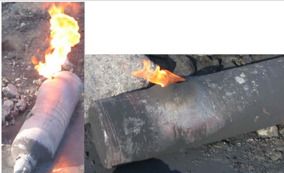
Figur 22 Utbuling på acetylenflaske ved ruptur
