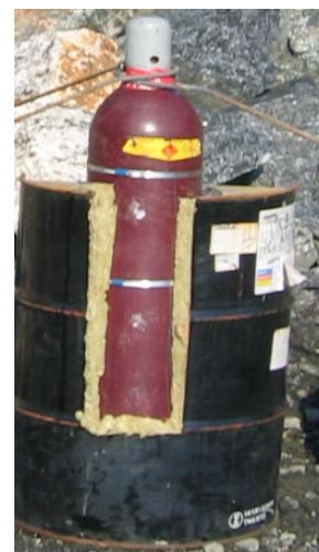
Figur 12 Acetylenflaske klar for beskytning
