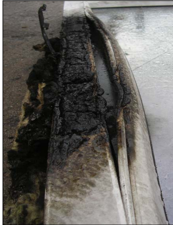
Figur 20: Vindusramme i PVC etter å ha blitt utsatt for brann
