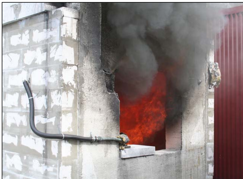
Figur 26: Bakre ventilasjonsåpning med fyllesystem
