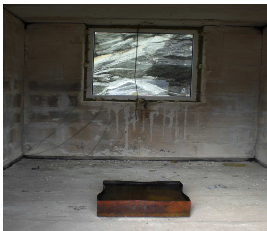
Figur 20. Plassering av kar med heptan i midten av testrommet.
