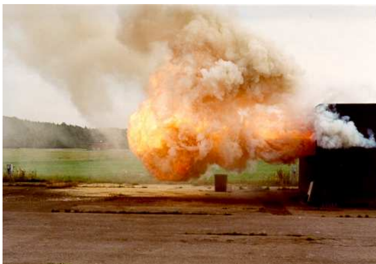
Bilde 1 Ildkule som slår ut av Backdraft container. Etter åpning av ventilasjonsåpning. Fullskala forsøk i backdraft container
