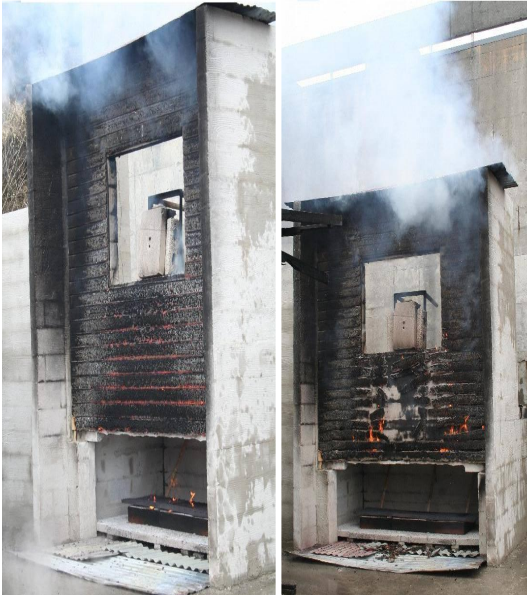
Bilde 8: Til venstre er riggen like etter at heptan brannen har stanset, til høyre viser kledningen 20min senere
