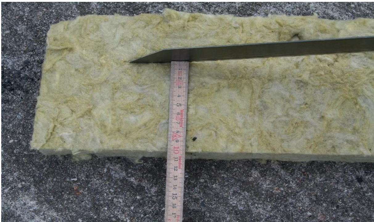
Bilde 2: Bildet viser en remse steinull som skal brettes dobbelt for å bli en dytt tilsvarende 50mm
