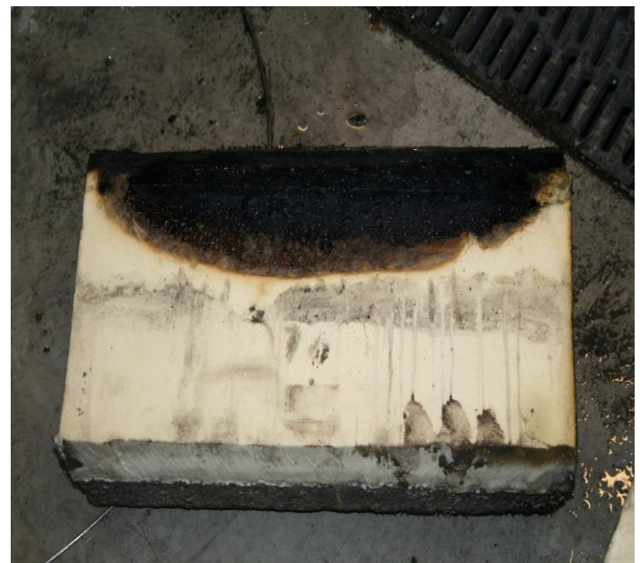
Bilde 3: Nederste fasadeblokk etter brenningen
