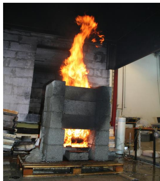
Bilde 6: Bildet viser brenning av ISOLITT med 100mm dytt i bunn av spalten
