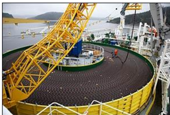
Bilde 2.6: Umbilical som holder på å bli lastet om bord på C/S Bourbon Skagerrak.
