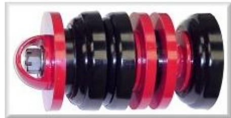
Bilde 1.9: eksempel på tetningspigget i polyuretan
