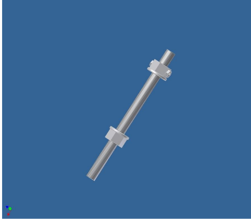
Figur 28. Tersebolt med to muttere for beregning.
