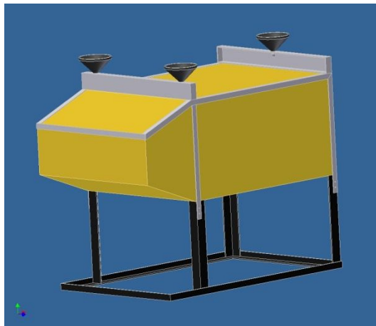
Figur 21. ROV med ramme og sugekopper.
