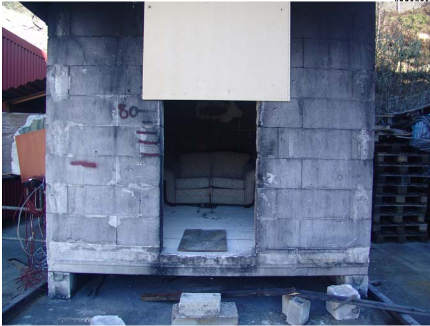
Figur 3.5: ISO rom med sofa og plate foran åpning
