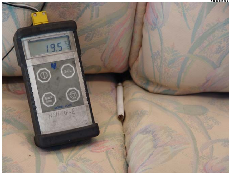
Figur 3.3: Oppsett for testing av sigarettens antennesstyrke
