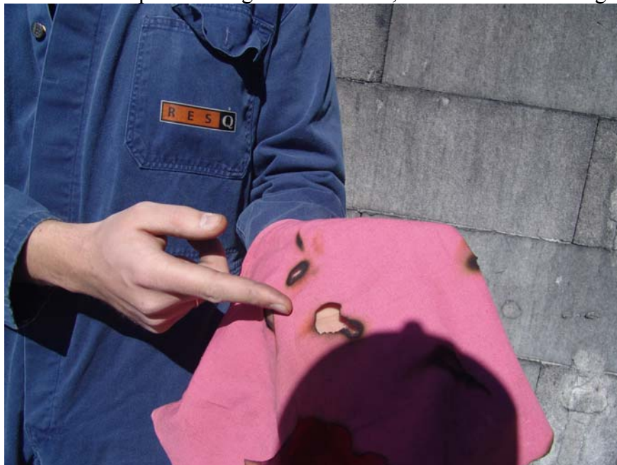
Figur 4.6: Resultat av forsøk 1. Sigaretten har forårsaket en ulming i putetrekket.
