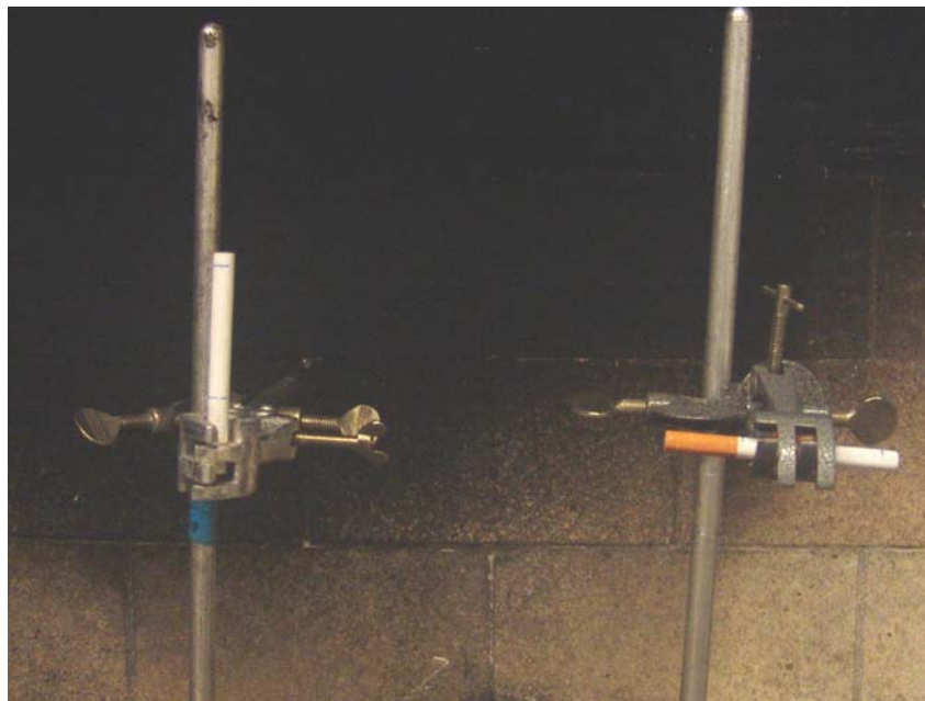
Figur 3.1: Sigaretten slik de ble testet. Her i posisjonene stående(t.v) og liggende(t.h).
