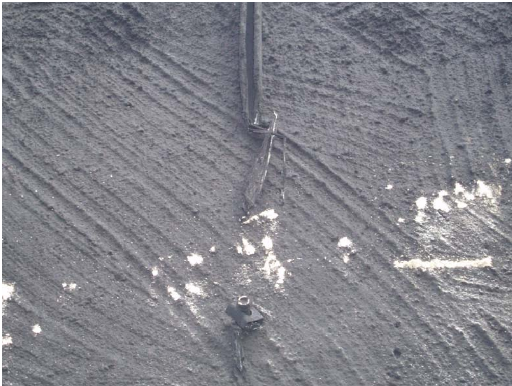
Figur 46 Vedlegg fullskalaforsøk – Detaljbilde av smeltet BI skinne forsøk 3
