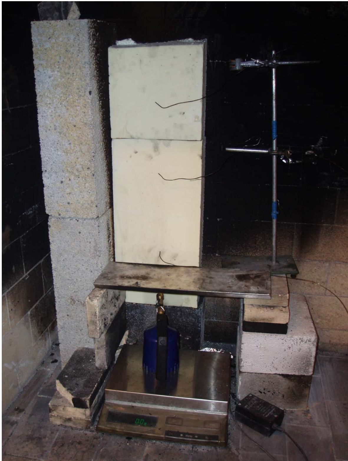
Figur 19 Vedlegg småskalaforsøk - Rigg med termoelement.
