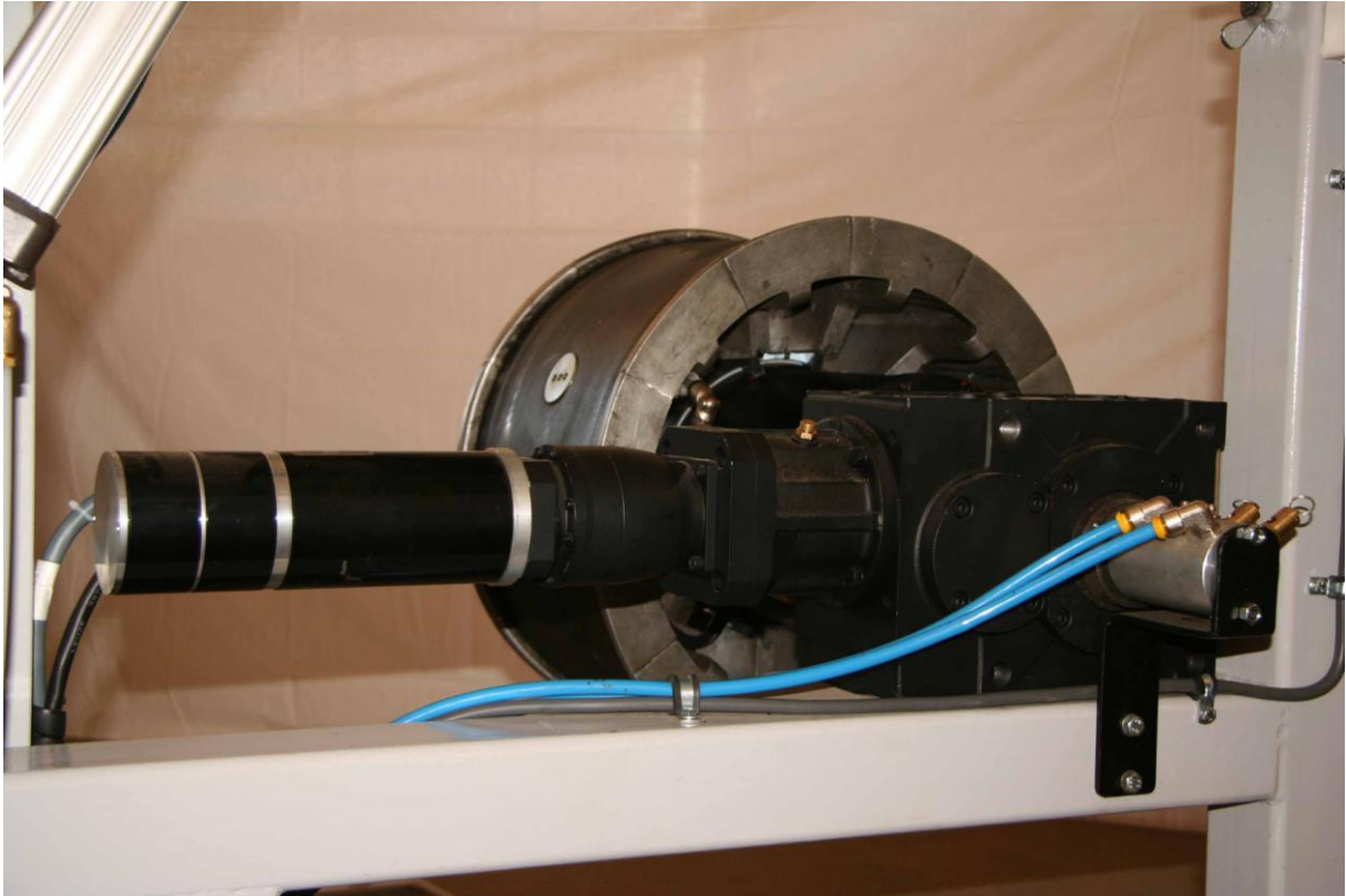
Motor og vinkelgir for rotasjon
