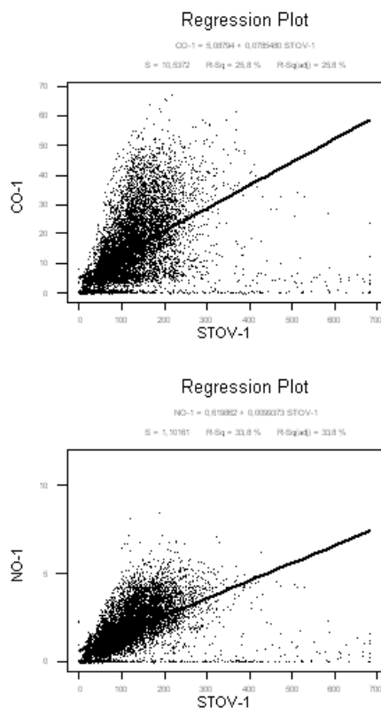
Figur 13 Plott av CO og NO mot støv i målepunkt 1 i testukene
