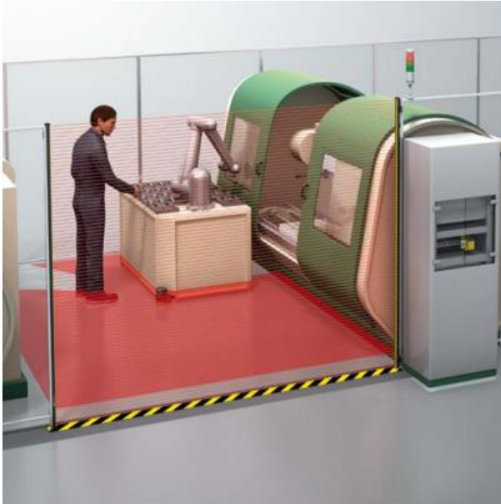
Figur 8: Faresone til robot som er beskytta av lysgardin. Henta frå vedlegg 3, side 9.
