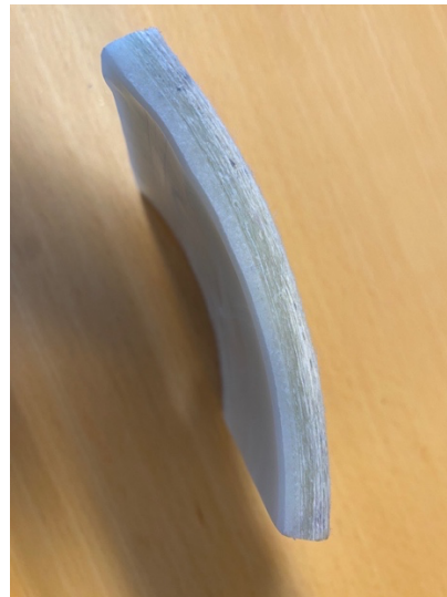
Figur 11 : Snitt av ferdig herdet IBB16.
