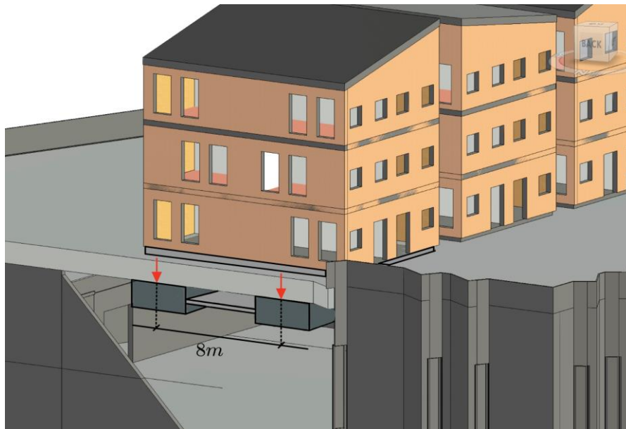
FIGUR 30. TO AKTIVE BETONGBJELKER UNDER STUDENTBOLIGENE
