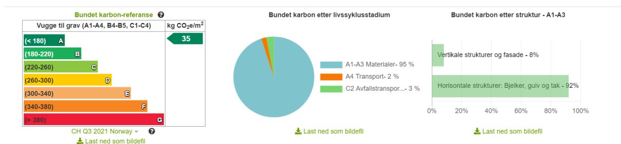
Figur 4343 - Bundet karbonreferanse for Bæresystem i betong(One Click, 2022)
