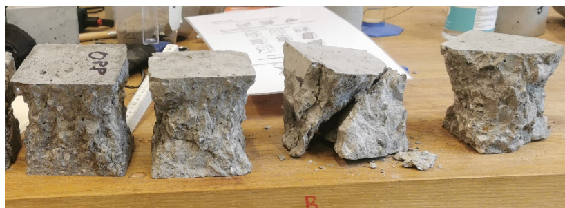
Figur 14: Brudd i betong. (Privat foto)
