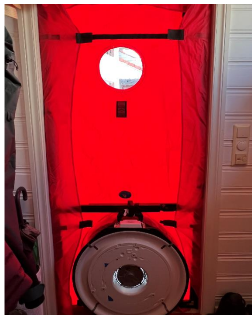
Figur 8: Privat foto av BlowerDoor.
