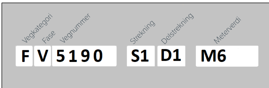
Figur 4 - Fv. 5190 Apeltunvegen vegsystemreferanse ved start i Skjoldskiftet
