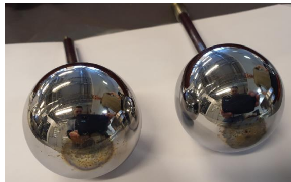
Figur 43 Korrosjon og degenerering på testkulene
