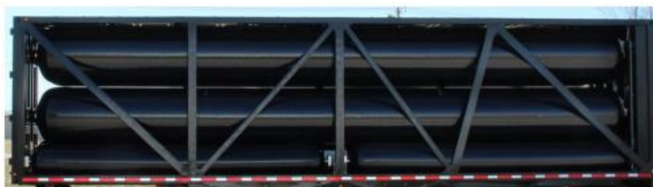
Figur 10: Eksempel på stabling av hydrogensylindrer
