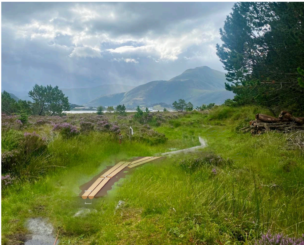
Figur 24: Visualisering av halvkloyvde, langsgående treklopper i delområdet «Starten på turen».
