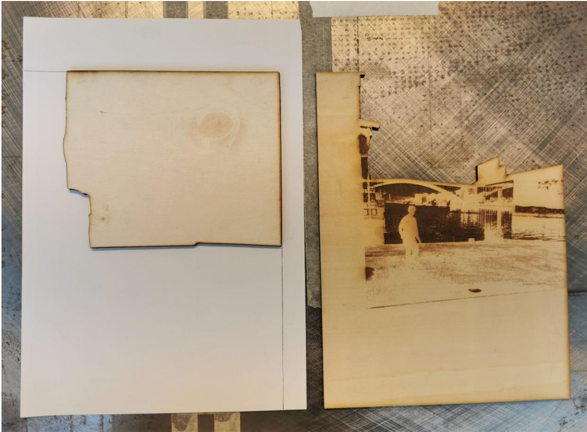
Figur 24. Til venstre: Kryssfinerplate kuttet uten programvare. Til høyre: Punktgrafikk-gravert lind, kuttet ut ved hjelp av linjeverktøy i Laserbox.
