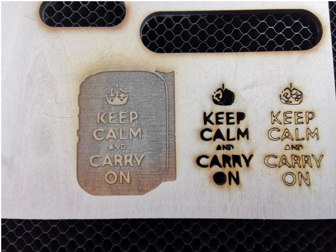
Figur 4. Foto av eksempler på punktgrafikk-gravering, vektorkutting og vektorgravering.
