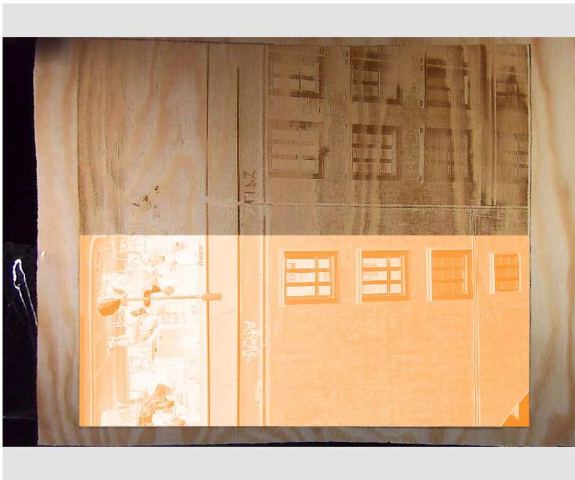
Figur 29. Skjermbilde av forsøk på å fortsette en gravering som ble avbrutt.
