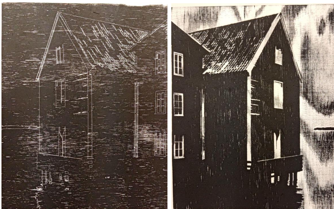
Figur 40. Linjegravert kryssfinerplate. Størrelse: 33 x 26 cm. Figur 41. Vektorgravert kryssfinerplate.
