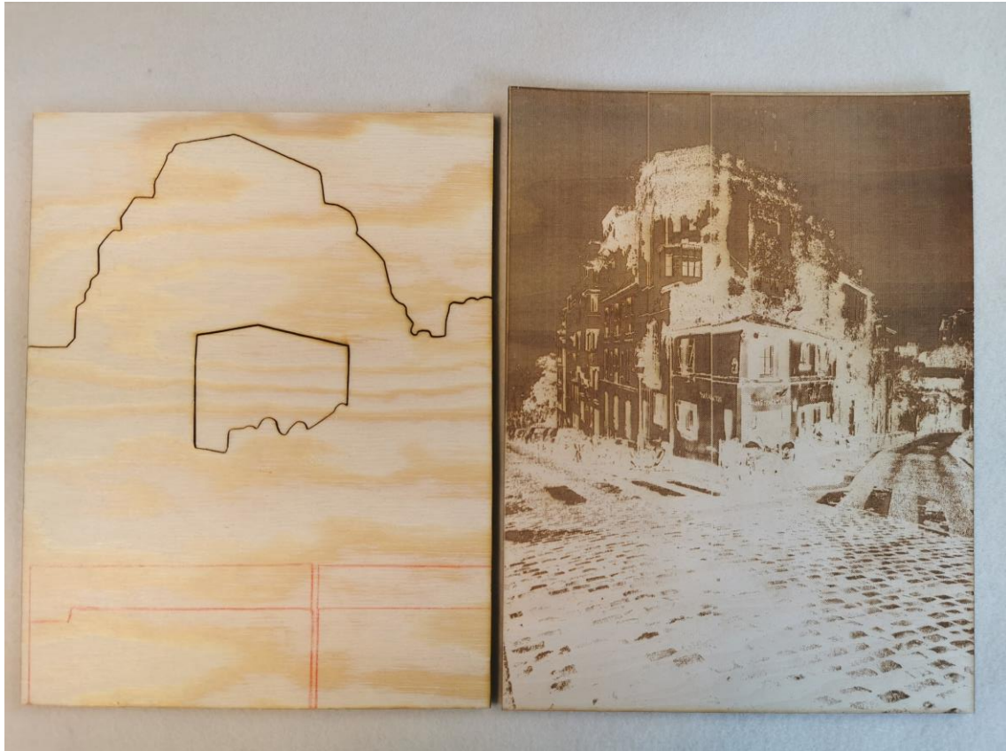
Figur 27. Venstre: Vektorkuttet kryssfinerplate. Høyre: Punktgrafikk-gravert lind. Merk at høyden på de to platene ikke er lik. Dette var en feilplassering av motivet på kryssfinerplaten.
