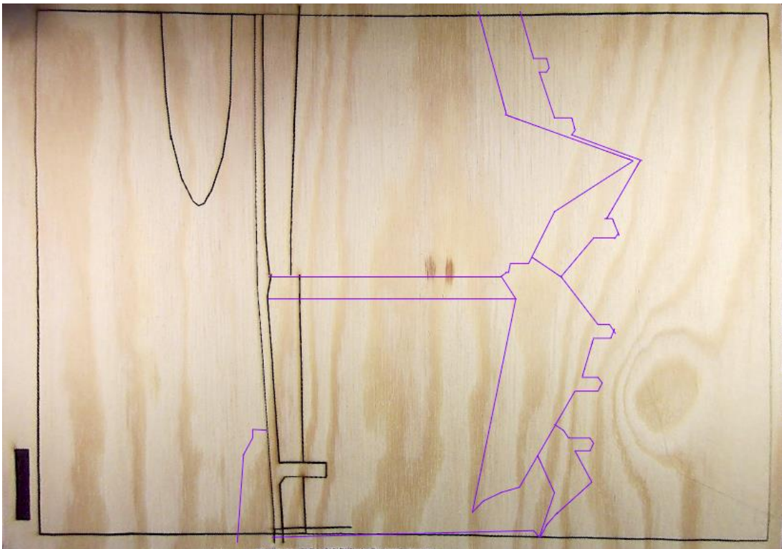
Figur 32. Skjerm bilde av Laserbox etter at laserkutteren ga feilmelding. For å fortsette jobben fjernet jeg alle linjene som var ferdig kuttet.
