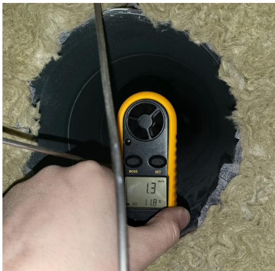
Figur 38: Avtrekk på 1,3 m/s, forsøk 1, 2 og 3.
