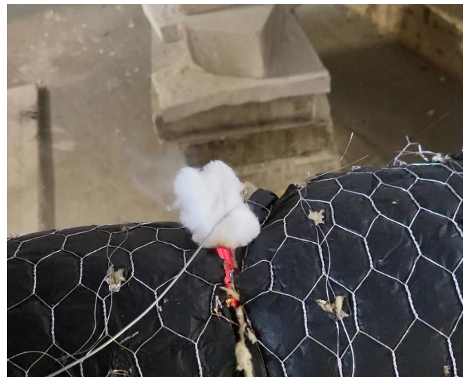
Figur 54: Bomulldott på skjøt mellom EI 15 brannisolering
