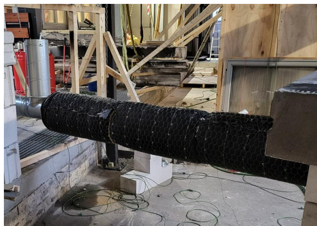
Figur 31: Brannisolering i 180 cm lengde(EI60).
