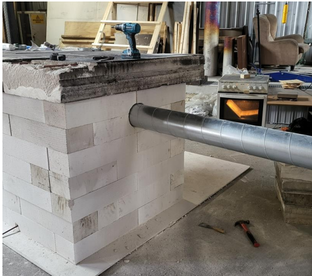
Figur 23: Gjennomføring før branntetting
