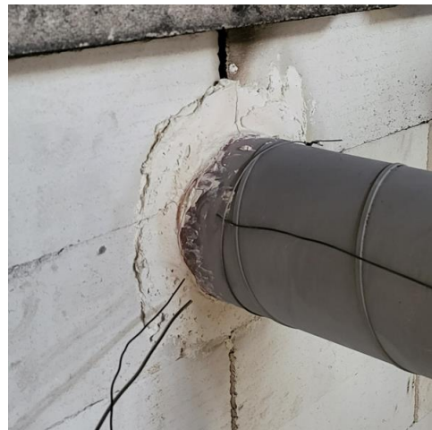
Figur 52: Plassering av termoelement på ueksponert side.
