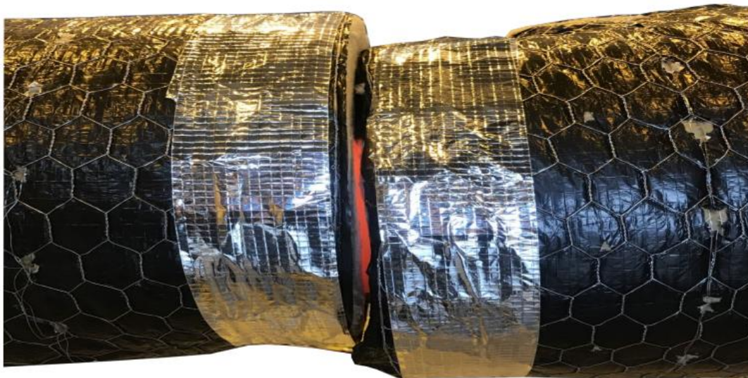
Figur 4-12 Bildet viser at ventilasjonskanalen er rødglødende bak isolasjonen. Kanalen har fått en liten knekk, som vist ved at to isolasjonsmatter har blitt forskjøvet i forhold til hverandre. Bildet er fra test 22.
