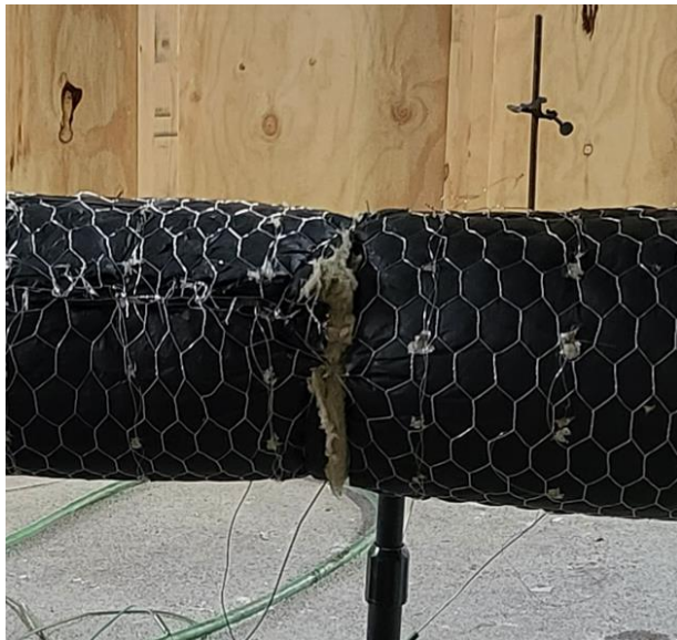
Figur 66: Skjøtt før forsøk
