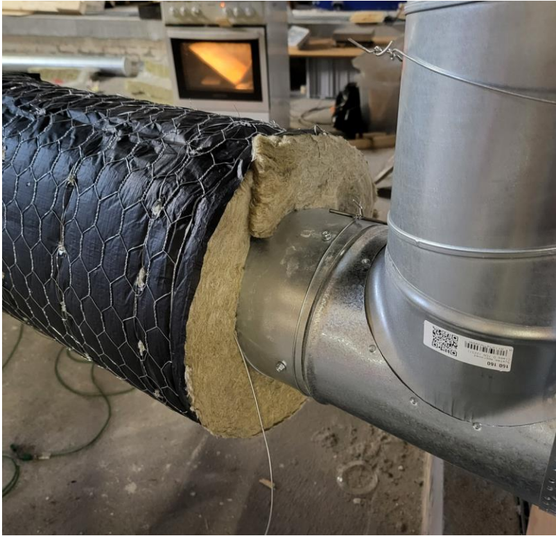
Figur 33: Temperaturmåler plassert rett etter isolering.
