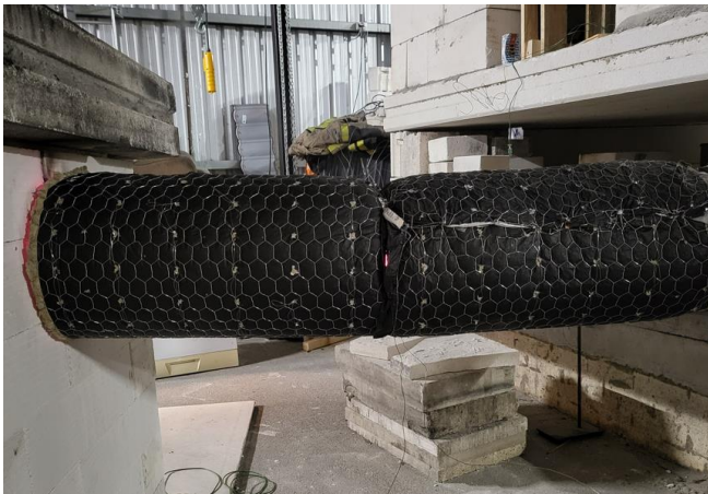
Figur 47: Brannisoleringen EI 60 rett etter forsøk
