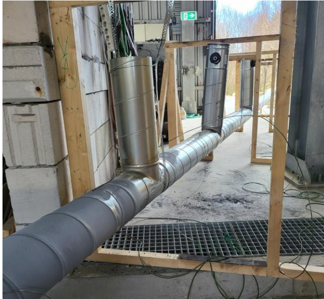
Figur 36: Oversikt over kanalstreck
