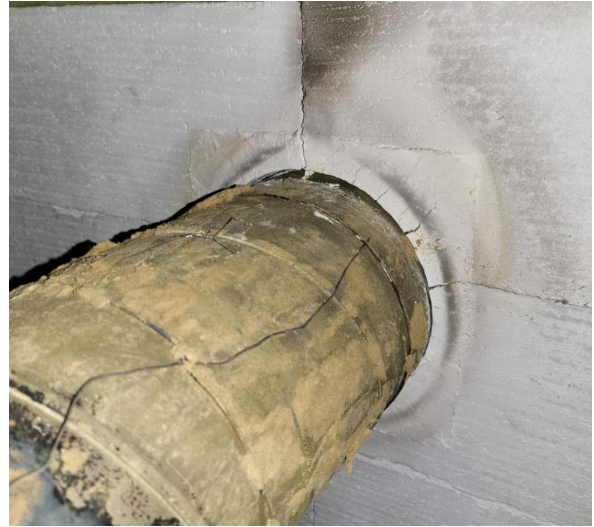
Figur 44: Branntettingen etter forsøk 1.
