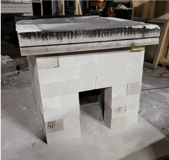
Figur 18: Ferdig bygget brannrom/ovn.
