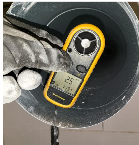
Figur 37: Avtrekk på 2,5 m/s i forsøk 4.
