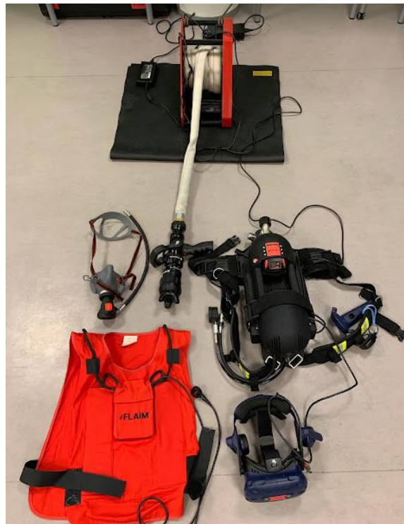
Figur 3 viser komplett utstyr av FLAIM trainer™
