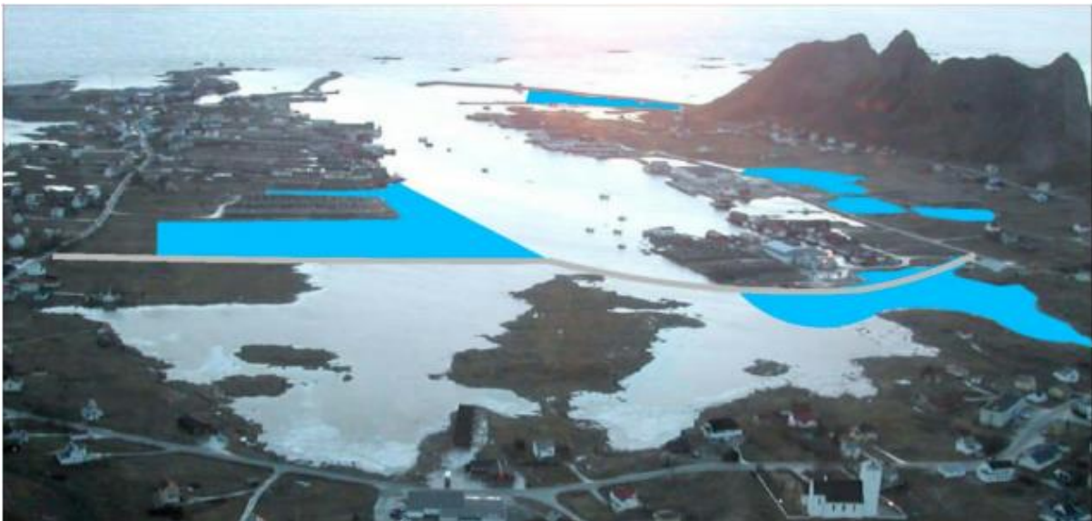
Figur 29 Illustrasjon av tiltak. Blått er utfylling, grått er vei. Hentet fra varoy.kommune.no
