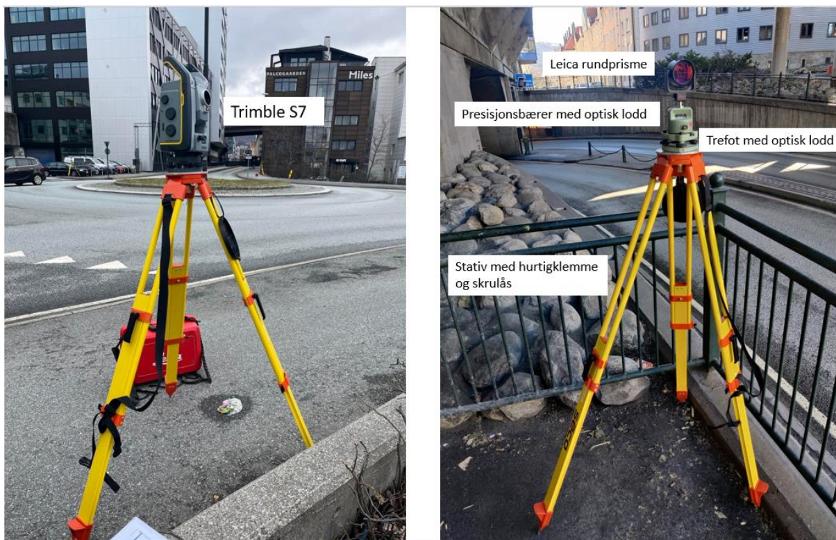
Figur 6 viser stasjonsoppstilling over FM4 med Trimble S7 (t.v.). Oppstilling med et rundprisme, presisjonsbærer med optisk lodd, trefot med optisk lodd som står på et stativ med hurtigklemme og skrulås (t.h.).
