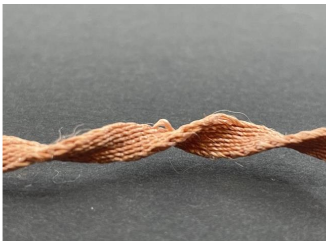
Figur 32 Vridd smykkeband. Løs renningstråd, skjøvet sammen. Fanny Edner Sand.
