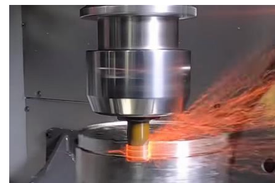
Figur 23 - Glødende fragmentkast fra keramisk endefres [55].
