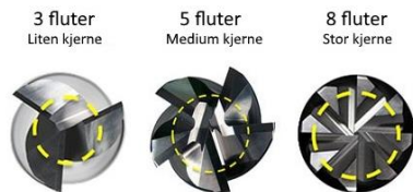
Figur 25 - Forklaring av kjerne på endrefres.
