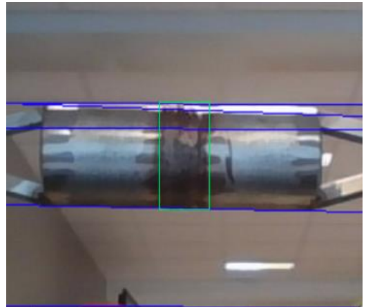
Figur 48 – Bilde klipt ut rundt boundingbox i figur 45, og deretter nyttet HoughLines funksjonen på.
