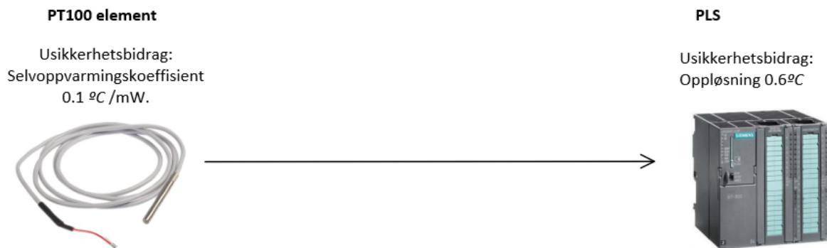
Figur 11 Illustrasjon av usikkerhet bidragene for PT100 element uten tekstilsokk
