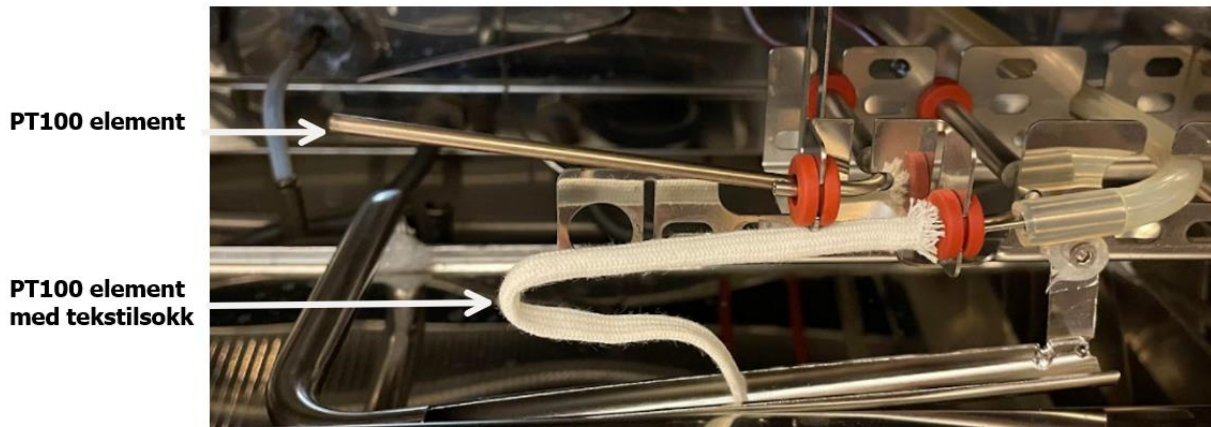
Figur 6 PT100 elementer for måling av temperatur og fuktighet
