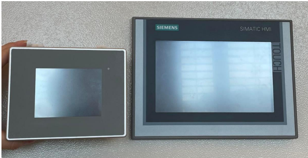
Figur 19 Eksisterende kontra nytt HMI-panel
