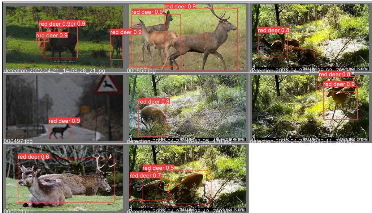
Figur 5.7: Modellens prediksjon på valideringssettet, merk at på bilde 1-3 og 3-1 og blir to hjorter identifisert som et individ.
