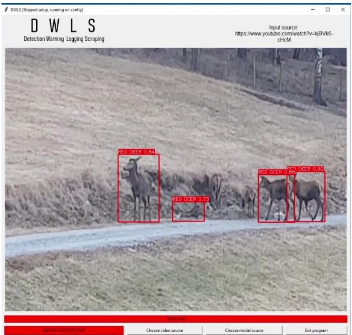
Figur 5.5: Bilde av den andre videoen "Hjortebading Vill Vest" brukt i brukertest. Merk at de to hjortene i midten ikke blir detektert. (Hegland, 2021)
