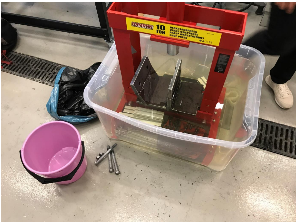
Figur 45: Testoppsett nedsenket i vann
