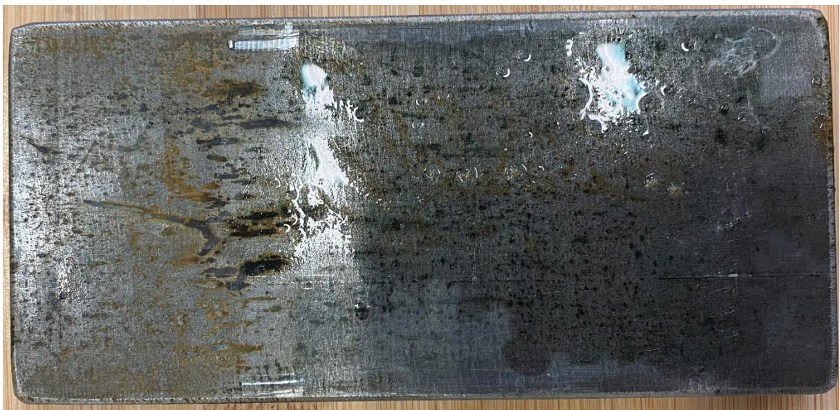
Figur 49: Skader på testplate uten overflatebehandling
