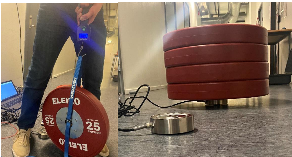
Figur 51: Måling av korreksjon av lastceller
