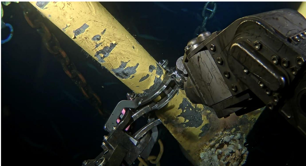
Figur 2: Eksempel subsea clamp, i bruk
