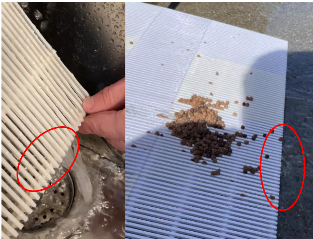
Figur 35: Forsøk med 145x150mm wedge wire med 45° vinkel
