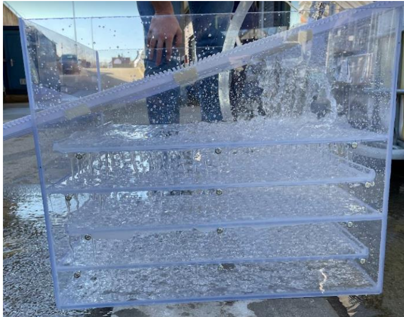
Figur 39: Vannfordeling i CO 2 -lufter
