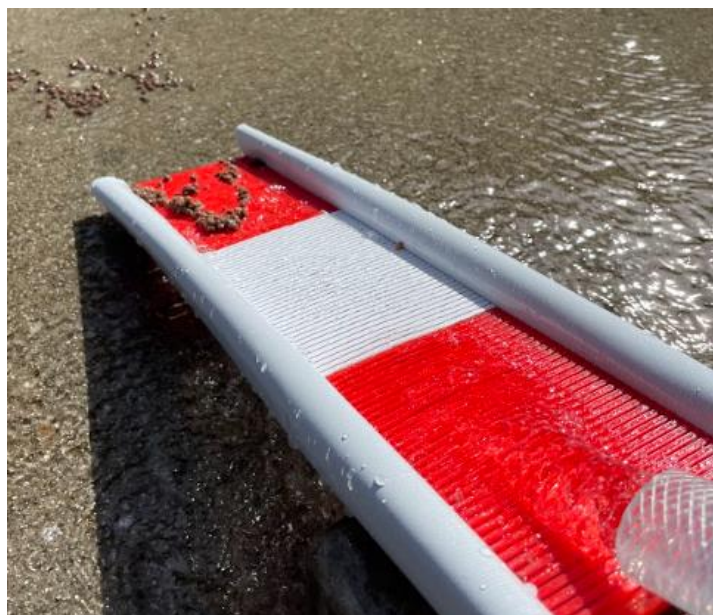
Figur 41: Forsøk med 1 mm spalteåpning
