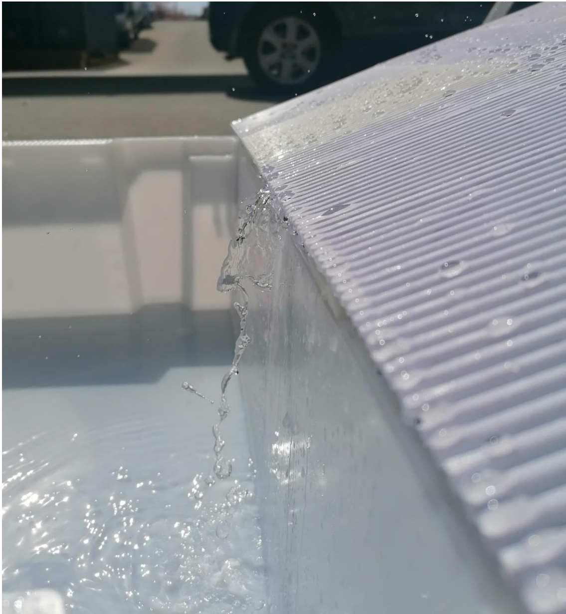
Figur 37: Bilde av hvordan vannet renner langs spilene på wedge-wire
