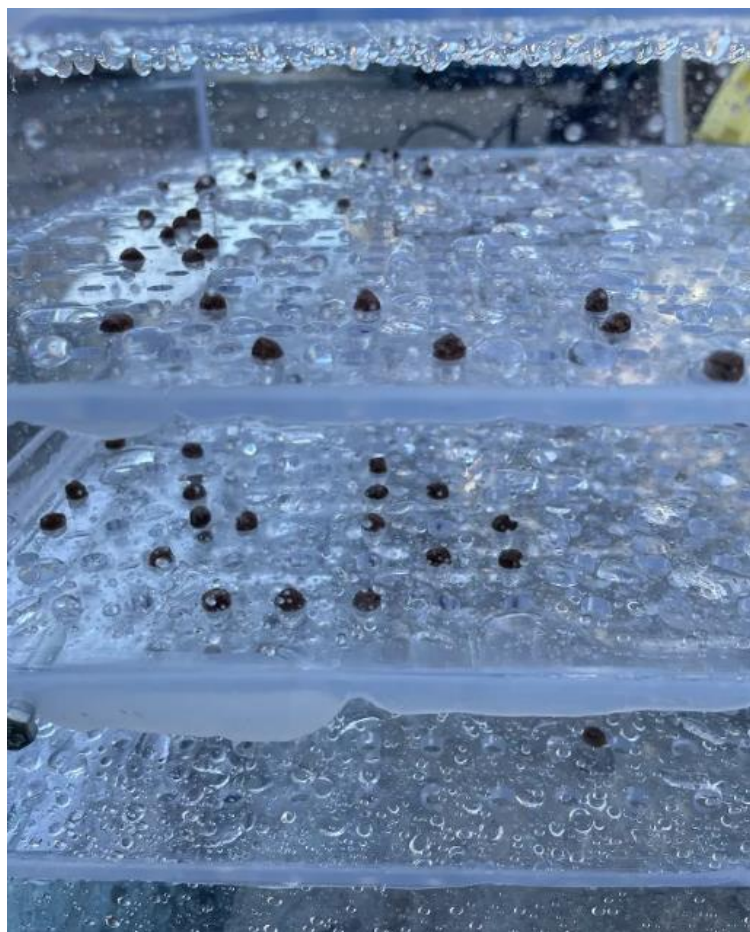
Figur 34: Bilde av hvordan fiskefôr tetter perforerte plater
