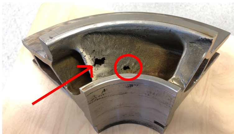
Figur 17: Skade på en impeller på grunn av kavitasjon og implodering
